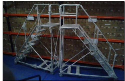
15 Escaleras metálicas tipo plataforma
